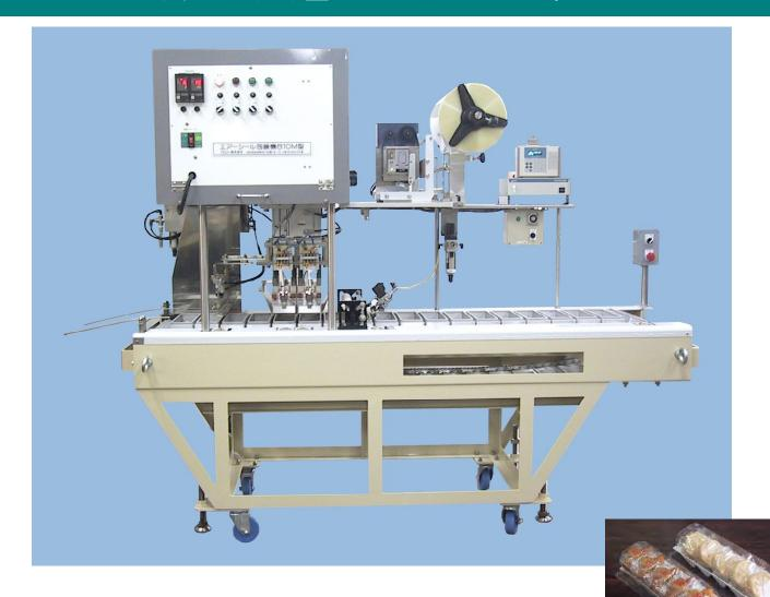
Wシールタイプ ガス充填装置、印字装置 ゼネバ駆動、 過負荷装置(トルクリミッター) バケットズレ、ワンタッチ無限装置 電源 AC200V 能力 1680 ケ/時 機械外寸法 長さ 2160 ×幅 800 ×高さ 1780 (コンプレッサー別)
